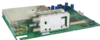
Zur Umsetzung von zwei QPSK-modulierten SAT-ZF- Signalen in zwei QAM-modulierte Nachbarkanäle im Frequenzbereich von 47 bis 862 MHz. Durch die integrierte Datenratenanpassung, PCR-Korrektur, PID-Filter sowie der NIT-Erstellung in beiden Kanälen ist die X-QAM twin 5 vielseitig anwendbar und zukunftssicher. Beide Ausgangskanäle können getrennt voneinander an- und abgeschaltet werden. Zur Pegelanpassung auf gleichen Ausgangspegel besitzt jede Karte einen von außen zugänglichen Pegelsteller.
